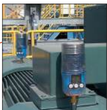
Automatický dávkovací systém ovládaný mikroprocesorem
